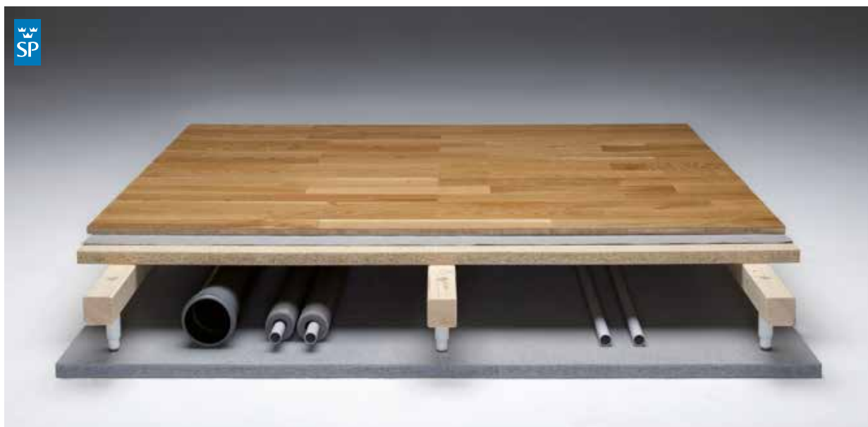
Exempel på golvkonstruktion med 15 mm parkett, P-märkt eller CE-märkt 22–38 mm golvspånskiva i lägst klass P6 som kan skarvas fritt mellan regler, 45 mm Nivellregel och Nivells plastskruv/akustik.
