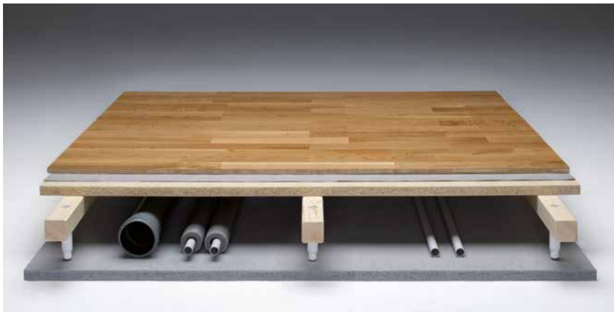
Nivellgolv akustik. Parkett – P-märkt eller CE-märkt golvspånskiva i lägsta klass P6 – Nivell plastskruv/akustik – Installationer – Nivellregel c/c 600
