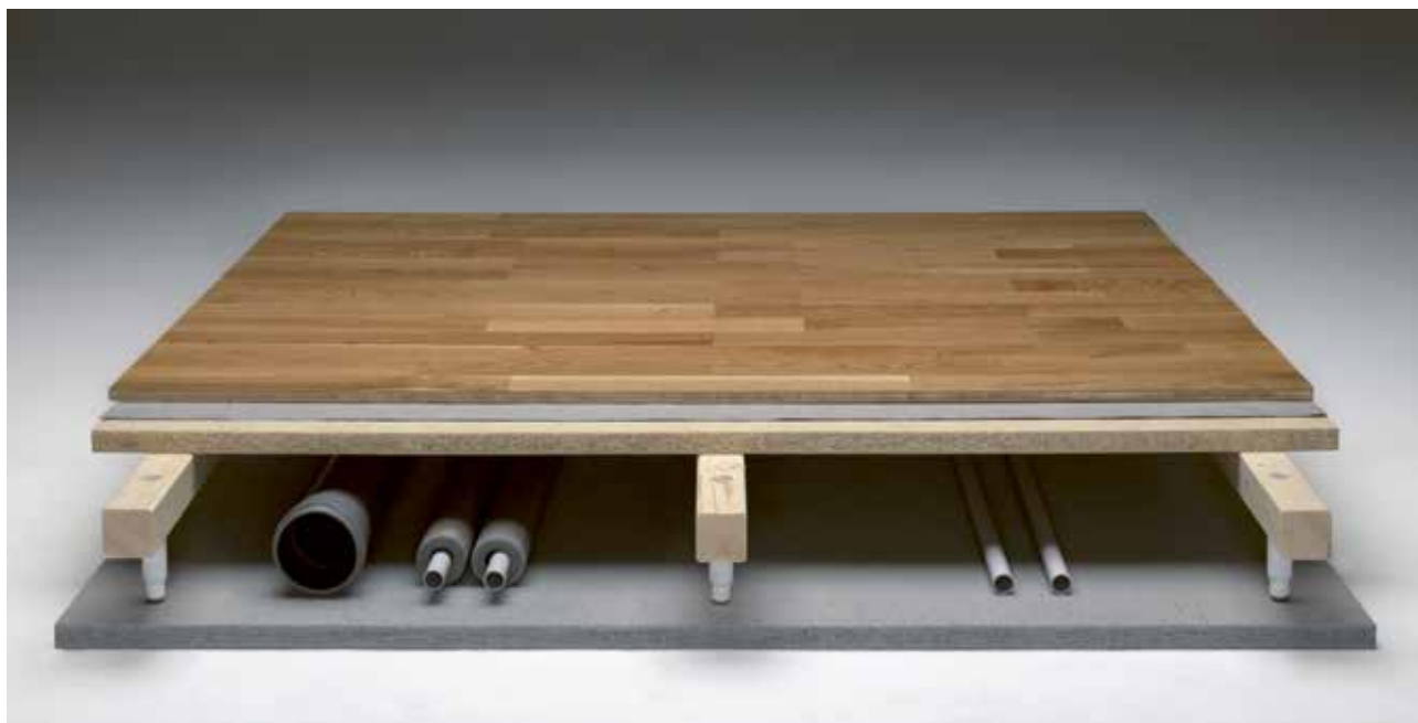
Nivellgolv akustik. Parkett – CE-märkt golvspånskiva i lägst klass P6 – Nivell plastskruv/akustik – Installationer – Nivellregel c/c 600
