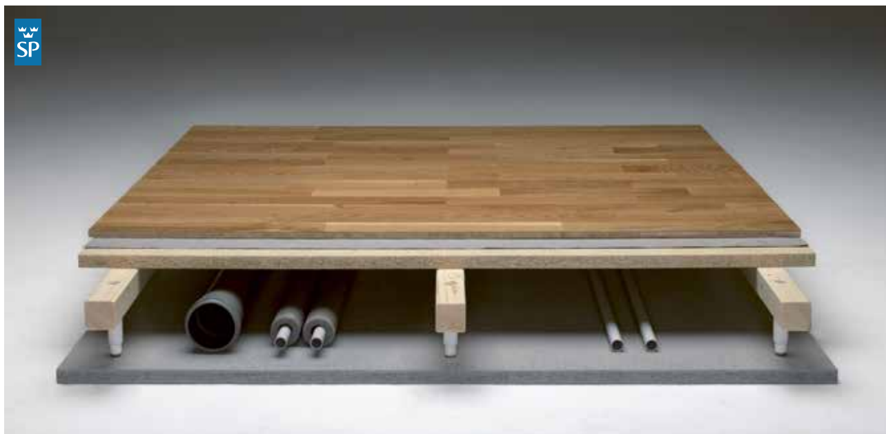
Exempel på golvkonstruktion med 15 mm parkett, CE-märkt 22–38 mm golvspånskiva i lägst klass P6 som kan skarvas fritt mellan reglar, 45 mm Nivellregel och Nivells plastskruv/akustik.
